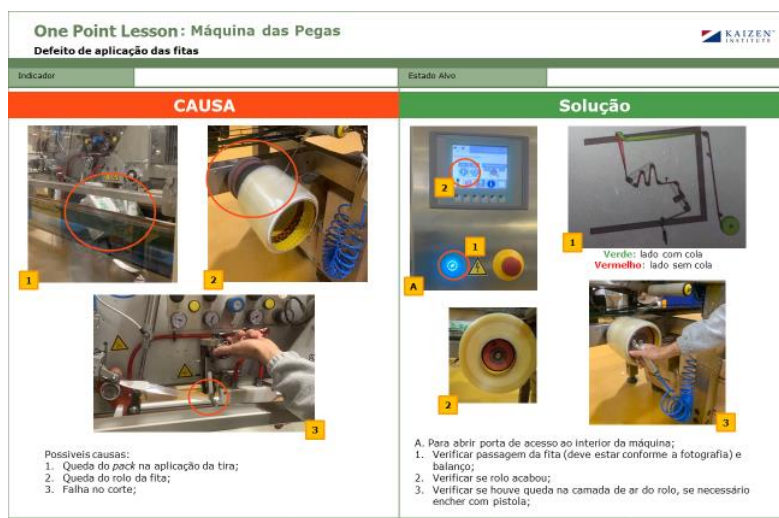
Figura 32 - Ação de melhoria resultante da reunião de equipa (instruções de como resolver problemas frequentes de uma máquina).
